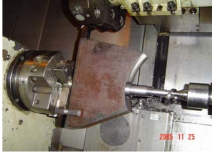
Usinage des Tourillons de Pales
