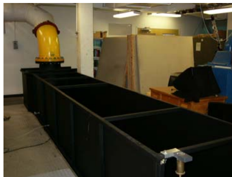
Vue du canal d'essai complet - alimentation au fond
