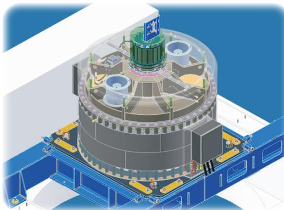
**L'alternateur** : PMGA a conçu un alternateur de 600 kW optimisé pour ce site et pour la vitesse de synchronisme de 75 tr/min .
