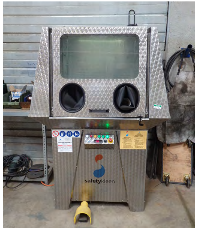
Photo : SSE_Fontaine de nettoyage_01
