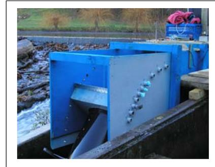
Vue aval de l'ensemble canal d'amenée, maquette de VLH avec possibilité de différents positionne-
