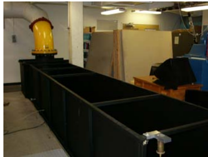
Vue du canal d'essai complet - alimentation au fond
