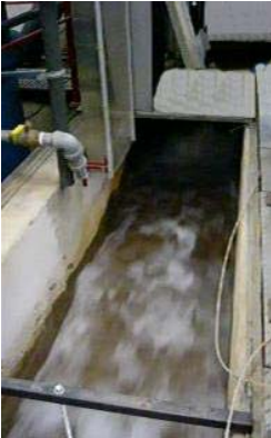
Canal de fuite
