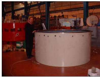
Enveloppe extérieure du stator
