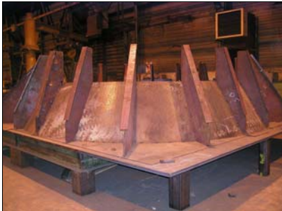
Distributeur en cours d'assemblage début septembre
