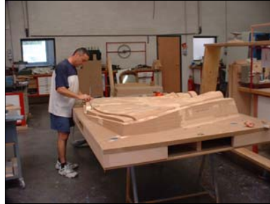
Moule en bois et résine pour la fonderie des pales
