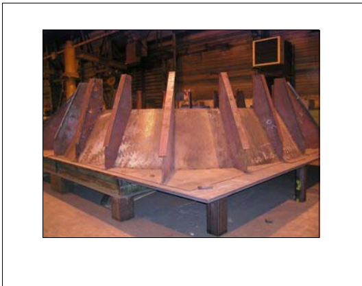
Distributeur en cours d'assemblage début septembre
