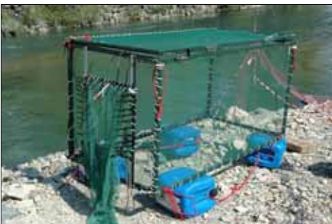
Nasse de récupération des exemplaires ayant franchi la turbine
