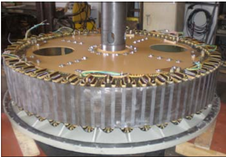
Stator en cours d'assemblage
